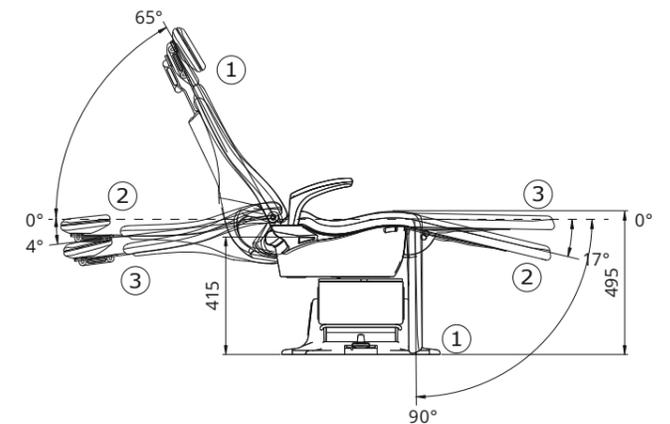
Le repose-jambes automatique en option, peut être utilisé lorsque le fauteuil est pivoté à 90° à gauche ou à droite.
