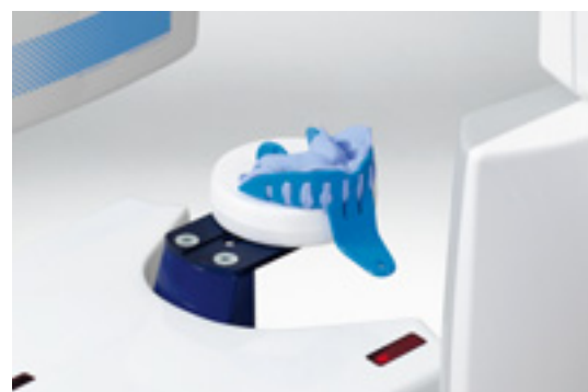
Scannage d'une empreinte en modèle numérique
