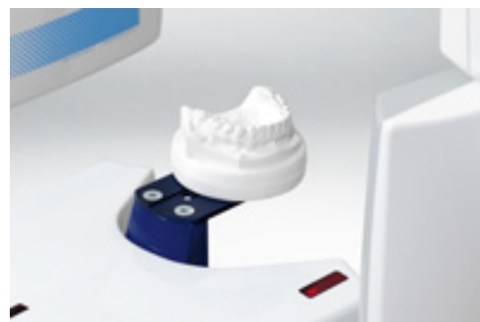
Scannage d'un moulage en plâtre en modèle numérique
